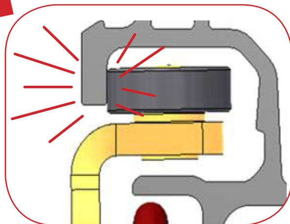
Die patentierte Trike Schiebepanzenrolle macht das Öffnen der Seitenteile zum Kinderspiel. Die durchdachte Form sorgt dafür, dass die Plane nie blockiert. Bei straff gespannten Planen, drückt die Rolle gegen die Aussenseite. Der Zuggurt läuft an der Schiene vorbei.
